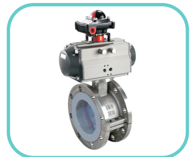
品名：气动衬氟蝶阀 公称口径：DN50-500 公称压力：PN10-16 作用型式：开关型/调节型 阀体材质：铸铁衬氟/铸钢衬氟 /不锈钢衬氟 阀座材质：PTFE 附件：电磁阀/限位开关/气源三联件/手轮/定位器
