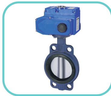
品名：电动软密封蝶阀 公称口径：DN50-800 公称压力：PN10-16 作用型式：开关型/调节型 阀体材质：铸铁/铸钢/不锈钢 阀座材质：橡胶 电压：DC24/AC24V/DC220 /AC220/AC380
