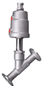
品名：全不锈钢气动快装角座阀 介质温度：-20℃~+180℃ 环境温度：-20℃~+60℃ 公称口径：DN10-DN65 公称压力：PN16 阀体材质：CF8/CF8M 阀座材质：PTFE
