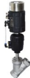
品名：调节型气动螺纹角座阀 介质温度：-20℃~+180℃ 环境温度：-20℃~+60℃ 气源压力：0.3~0.8MPa 公称口径：DN15-DN100 公称压力：PN16 定位器：智能型阀门定位器
