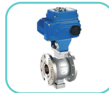
品名：电动V型球阀 公称通径：DN25-500 公称压力：PN16-320 作用型式：开关型/调节型 阀体材质：铸钢/不锈钢 阀座材质：PTFE/PPL/H/Y 电压：DC24/AC24V/DC220 /AC220/AC380
