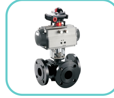
品名：气动三通球阀 公称通径：DN15-300 公称压力：PN16-320 作用型式：开关型/调节型 阀体材质：铸钢/不锈钢 阀座材质：PTFE/PPL/H/Y 附件：电磁阀/限位开关/气源三联件/手轮/定位器
