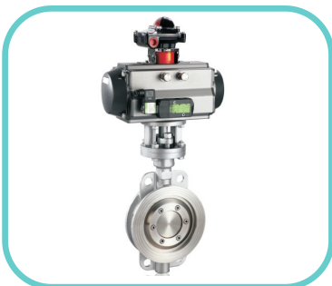
品名：气动硬密封蝶阀 公称口径：DN50-800 公称压力：PN10-25 作用型式：开关型/调节型 阀体材质：铸钢/不锈钢 阀座材质：H/Y 附件：电磁阀/限位开关/气源三联件/手轮/定位器
