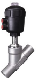
品名：气动焊接角座阀 介质温度：-20℃~+180℃ 环境温度：-20℃~+60℃ 气源压力：0.3~0.8MPa 公称口径：DN15-DN100 公称压力：PN16 阀体材质：CF8/CF8M
