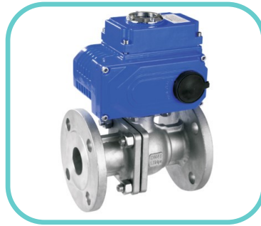
品名：电动法兰球阀 公称通径：DN15-400 公称压力：PN16-320 作用型式：开关型/调节型 阀体材质：铸钢/不锈钢 阀座材质：PTFE/PPL/H/Y 电压：DC24/AC24V/DC220/AC220
