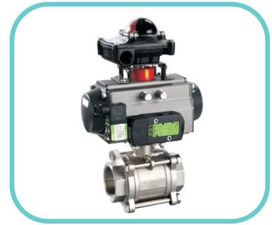
品名：气动内螺纹球阀 公称通径：DN10-100 公称压力：PN16-320 作用型式：开关型/调节型 阀体材质：铸钢/不锈钢 阀座材质：PTFE/PPL 附件：电磁阀/限位开关/气源三联件/手轮/定位器
