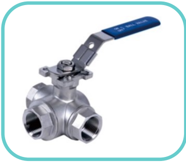
品名：内螺纹高平台三通球阀 规格：1/2"-2" 材质：CF8/CF8M 压力：PN63/100WOG
