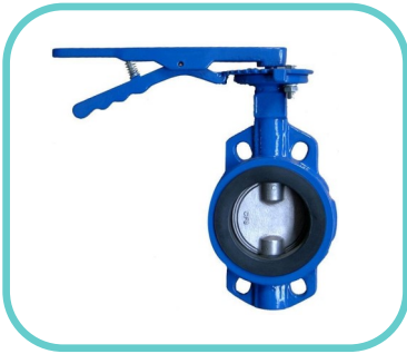
品名：手动软密封蝶阀 公称口径：DN50-800 公称压力：PN10-16 作用型式：手动 阀体材质：铸铁/铸钢/不锈钢 阀座材质：橡胶
