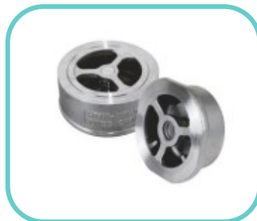
品名：H71对夹式止回阀 规格：2"-20" 材质：CF8/CF8M/WCB 压力：PN25/PN40/150LB/300LB
