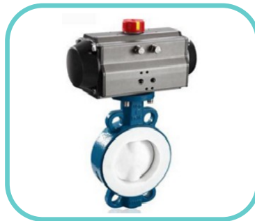
品名：气动软密封蝶阀 公称口径：DN50-500 公称压力：PN10-16 作用型式：开关型/调节型 阀体材质：铸铁/铸钢/不锈钢 阀座材质：PTFE 附件：电磁阀/限位开关/气源三联件/手轮/定位器
