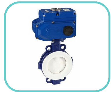
品名：电动软密封蝶阀 公称口径：DN50-500 公称压力：PN10-16 作用型式：开关型/调节型 阀体材质：铸铁/铸钢/不锈钢 阀座材质：PTFE 电压：DC24/AC24V/DC220 /AC220/AC380
