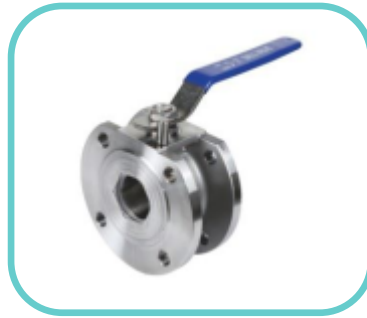
品名：手动薄型法兰球阀 尺寸：DN15-DN300 材质：CF8/CF8M/CF3M/WCB 压力：PN16/PN40 带锁/不带锁
