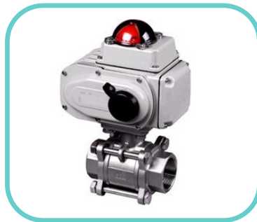
品名：电动内螺纹球阀 公称通径：DN10-100 公称压力：PN16-320 作用型式：开关型/调节型 阀体材质：铸钢/不锈钢 阀座材质：PTFE/PPL 电压：DC24/AC24V/DC220 /AC220/AC380
