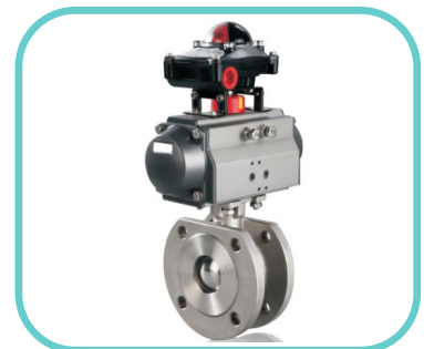
品名：气动超薄球阀 公称通径：DN15-150 公称压力：PN16-40 作用型式：开关型/调节型 阀体材质：铸钢/不锈钢 阀座材质：PTFE/PPL 附件：电磁阀/限位开关/气源三联件/手轮/定位器
