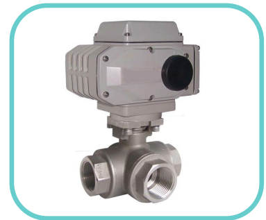
品名：电动三通球阀 公称通径：DN15-300 公称压力：PN16-320 作用型式：开关型/调节型 阀体材质：铸钢/不锈钢 阀座材质：PTFE/PPL/H/Y 电压：DC24/AC24V/DC220 /AC220/AC380
