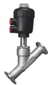
品名：气动快装角座阀 介质温度：-20℃~+180℃ 环境温度：-20℃~+60℃ 公称口径：DN15-DN65 公称压力：PN16 阀体材质：CF8/CF8M 阀座材质：PTFE
