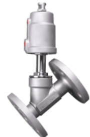
品名：全不锈钢气动法兰角座阀 介质温度：-20℃~+180℃ 环境温度：-20℃~+60℃ 气源压力：0.3~0.8MPa 公称口径：DN15-DN100 公称压力：PN16 阀体材质：CF8/CF8M 阀座材质：PTFE
